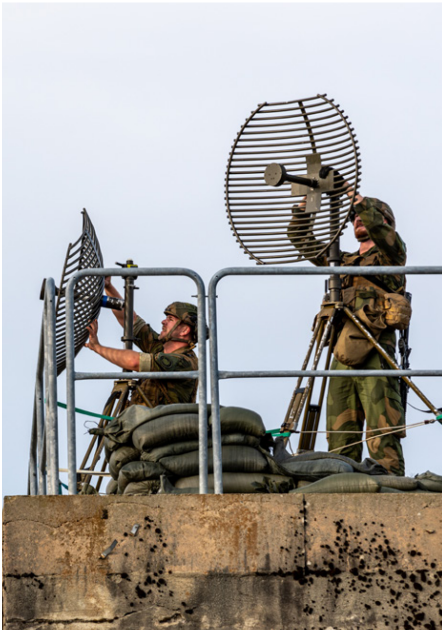
Luftvernartillerister setter opp antenner til NASAMS III (Norwegian Advanced Surface to Air Missile System) under øvelsen Falcon Response 2020 på Luftforsvarets base Rygge. Foto: Ingeborg Gloppen Johnsen / Forsvaret
